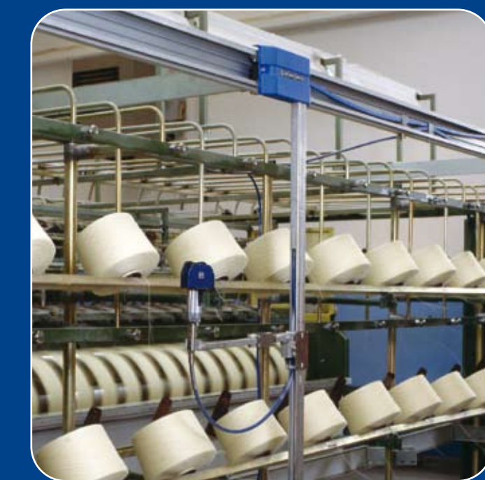
ATS tipo "C" con guida a terra e Jointair 115 montato su slitta per giuntare a diverse altezze filati di lana pettinata sulla cantra di una aspatrice.
