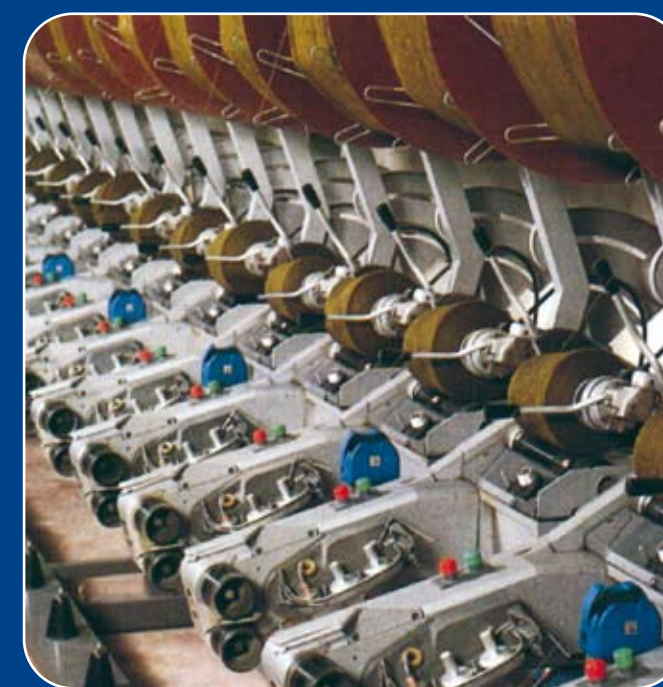
Jointair 115 in posizione fissa ogni due teste su dipanatrice che lavora filato misto lana/acrilico.
