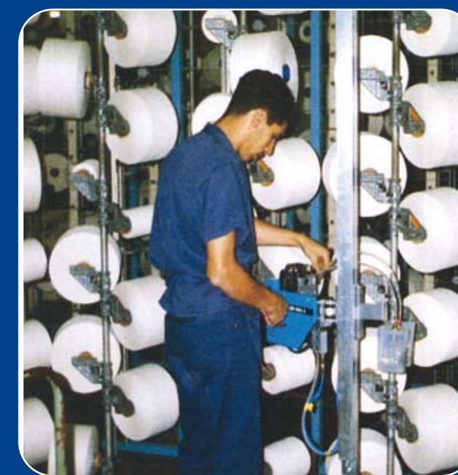
ATS tipo "L" con Aquasplicer 4923B montato su slitta per giunzione testa coda a diverse altezze su cantra di orditoio frazionale cotoniero.
