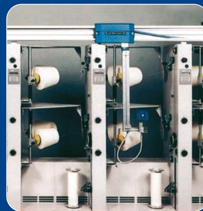
ATS tipo "C" con Jointair 115 installato su una accoppiatrice che lavora filati misti di poliestere e cotone.
